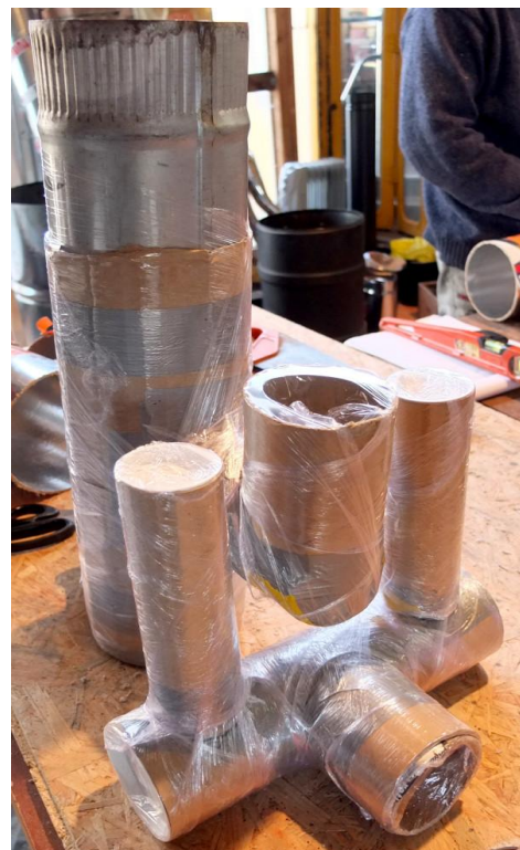
L'ensemble prêt à placer dans le bidon, recouvert de cellophane (Pito 60)
