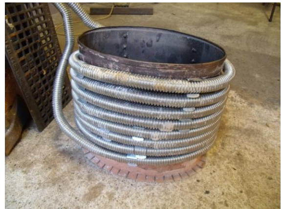
Cloche ECS : monotube inox enroulé autour de la cloche pour produire de l'eau chaude sanitaire (ECS)
