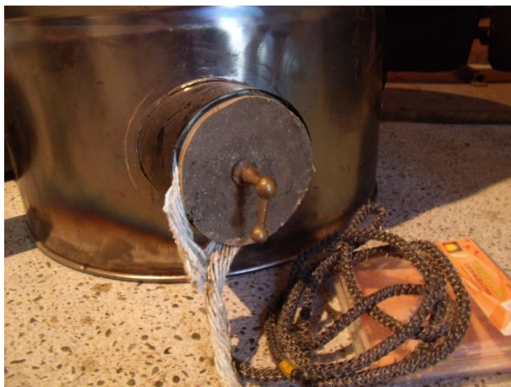
Bouchons (coniques ou non) pour les trappes de ramonage du collecteur. A rendre le plus étanche possible au moyen de joint minéral.
