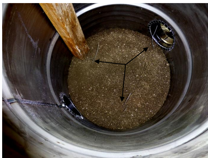
Vue de l'intérieur : les 3 fils de fer et le détail de la fixation des 2 tubes (cendrier et évacuation).
