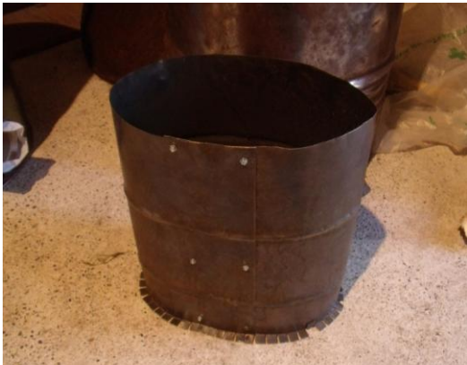
Cloche Pito200 : En fonction du diamètre du bidon de 60 litres il te faudra peut être le rétreindre (découpe et vis) pour qu'il s'ajuste à tes reprises de fumées
